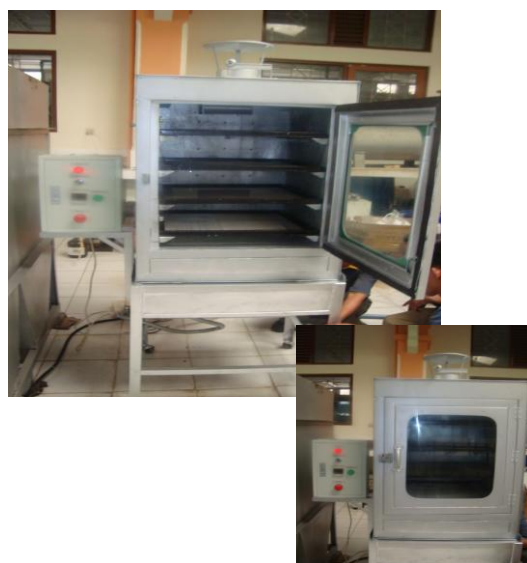
Gambar 6 Hasil Rancang Bangun Alat Pengering
